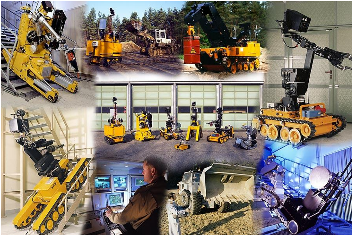
Fig.1: La flotte KHG allant du petit robot d'inspection pour tuyaux d'un diamètre minimum de 0,2 m jusqu'à une pelleuse de 25T .
