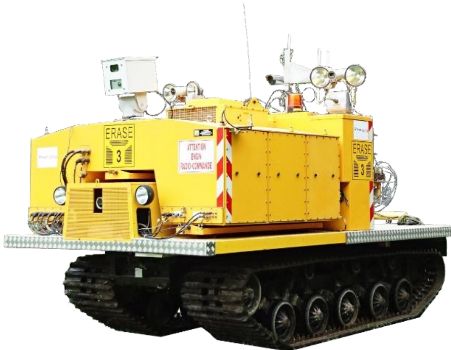
Fig.2: Robot lourd (6T) équipé d'un bras articulé de plusieurs mètres pour la manipulation d'équipements à l'extérieur: ERASE.
