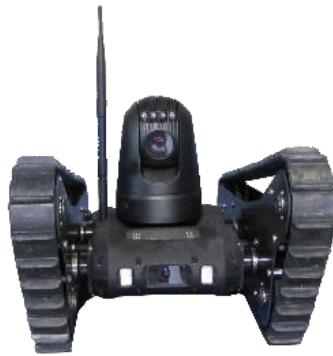
Fig.1 : Exemple de petit robot terrestre pour exploration visuelle et radiologique – NERVA XX de chez NEXTER.
