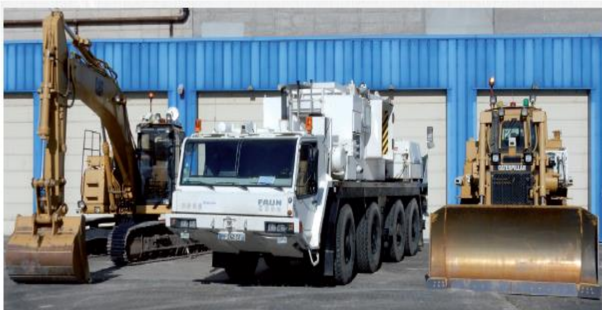
Fig.4 : Flotte d'engins de travaux publics lourds téléopérés : EPELL, EPPB, EBULL.
