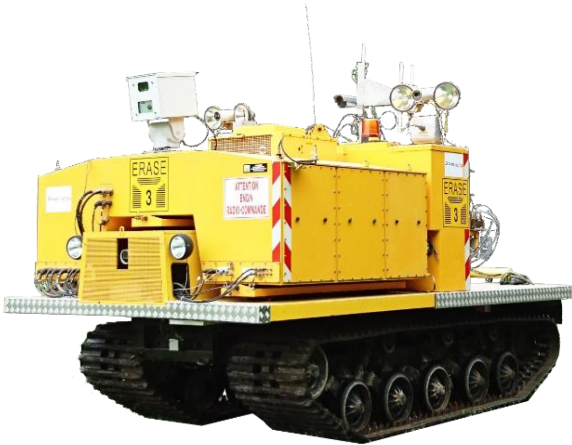
Fig.3 : Robot terrestre lourd équipé d'un bras articulé d'une élongation de plusieurs mètres pour reconnaissance et manipulation à l'extérieur : ERASE.
