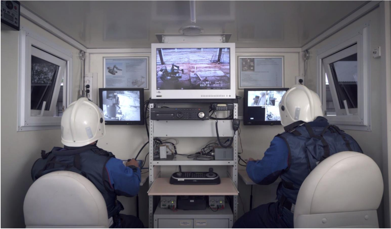
Fig.5 : Exemple de poste de pilotage à 2 places aménagé en camion
