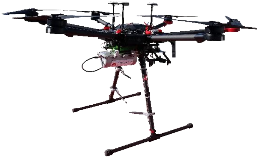
Fig.5 : Drone grande envergure, emport 5 kilos : MATRICE 600 de chez DJI.
