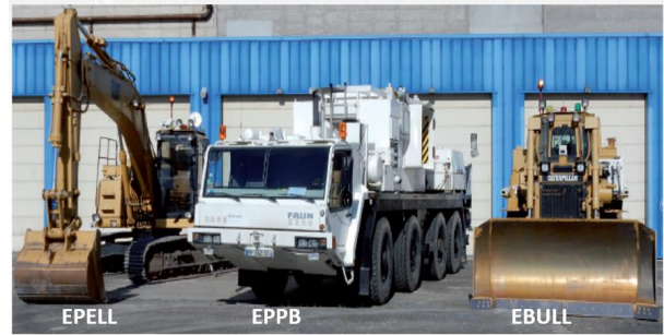
Fig.1 : Echantillon de la flotte d'engins téléopérés du groupe INTRA robotics.
